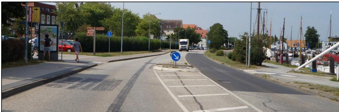
**Abb. 17** Beispiel Umnutzung der Flächen einer Busbucht für eine Querungsstelle
